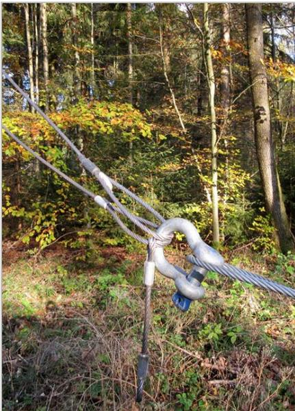
3. Die Schlaufen des Baumzugseiles werden anschließend mittels Schäkkel mit dem Hauptwindenseil verbunden, sodass das Baumzugseil umgelegt um den zu ziehenden Baum liegt.
