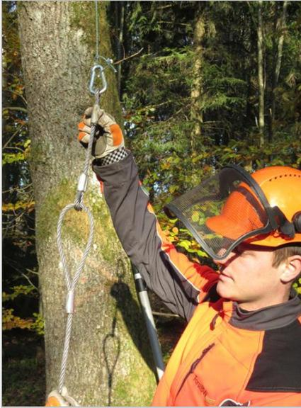
2. Die Einzugsöse des Stahlseiles wird mit dem kleinen Karabiner am unteren Ende der Reep Schnur befestigt. Nun zieht man das Stahlseil mit der Reep Schnur hoch in den Baum und über die Astgabel. Die kurze Einzugsöse sorgt dafür, dass das Baumzugseil gut über die Astgabel rutscht.
